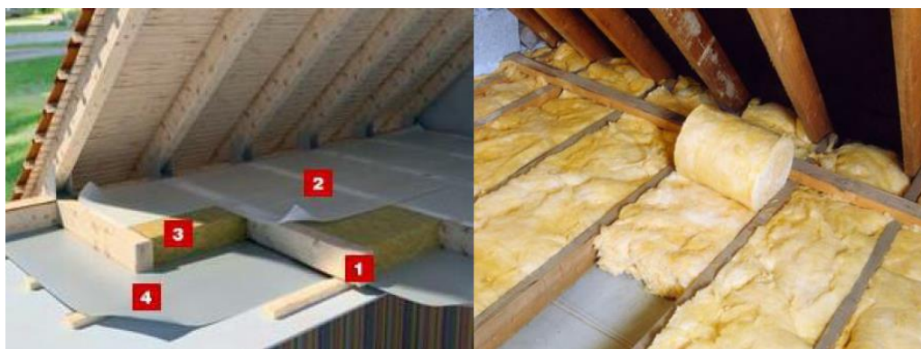
Загальний вигляд технології утеплення перекриття горища: 1 - вологонепроникний шар; 2 - мембранний шар; 3 - мінеральна вата; 4 - супердифузійна мембрана.
